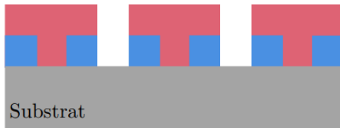
(g) Trockenätzen von \text{SiO}_2
