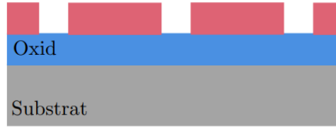
(b) Belichten und Entwickeln
