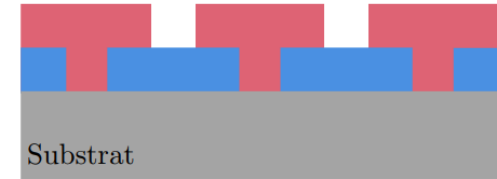
(f) Belichten und Entwickeln
