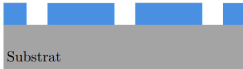
(d) Lack-Strip und Reinigung
